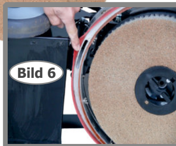
Bild 5 Ansaugöffnung kontrollieren und wenn notwendig reinigen (Bild 5 und 6).
