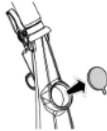
**2** Gießen Sie sauberes Wasser mit oder ohne Reinigungsmittel in den Behälter. Achten Sie beim Einsatz von Reinigungsmitteln auf die vom Hersteller vorgegeben Konzentrationen und die Eignung für die zu reinigende Fläche.
