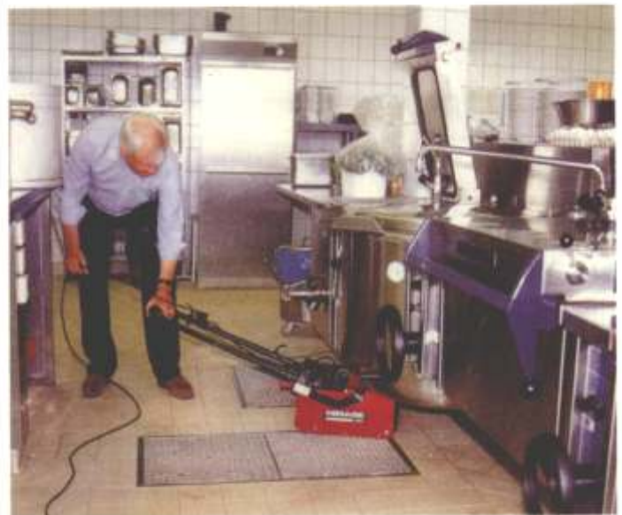
Miramaschef Karl Heinz Nothacker demonstriert in der Küche der Autobahnraststätte Würzburg die Reinigung von rutschfesten Bodenfliesen, die allenthalben Probleme mit sich bringt bei Verwendung herkömmlicher Maschinen.
